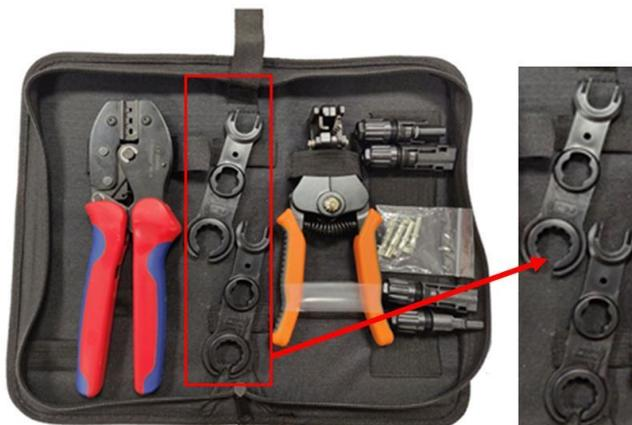
Herramienta para conexión/desconexión
